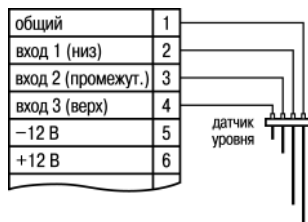
Рисунок 5.3 – Схема подключения кондуктометрических датчиков уровня
